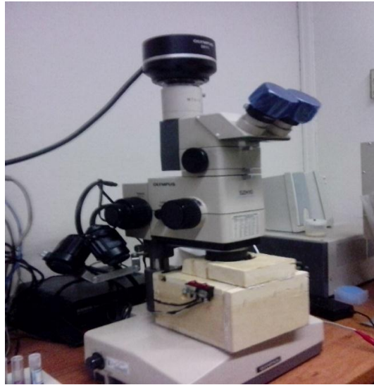
شکل ۱. سامانه‌ی تصویربرداری مورد استفاده به همراه حعبه‌ی تصویربرداری ساخته شده.
