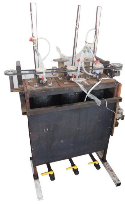
شکل ۲- مجموعه هاضم‌های بی‌هوازی
