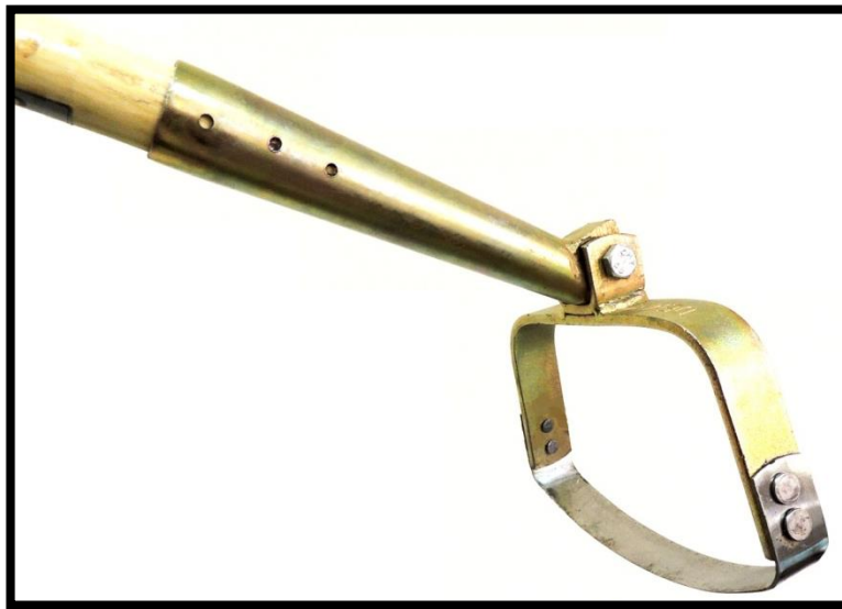
شکل ۳: تصویر و جین کن ساخته شده نهایی
