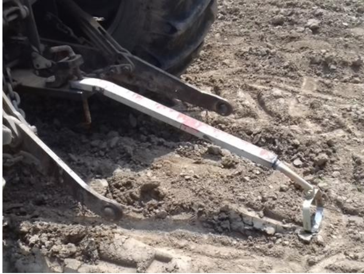
شکل ۴: شاسی تهیه شده جهت تست سایش
