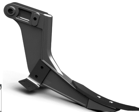
شکل ۱- مدل سه‌بعدی خاک‌ورز چیزل پیلر طراحی به کمک solidworks2016.
