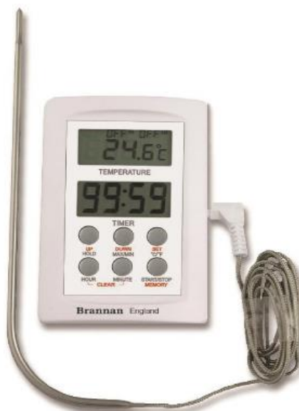
شکل ۳- دماسنج مورد استفاده برای اندازه گیری دمای گازهای خروجی اگزوز
