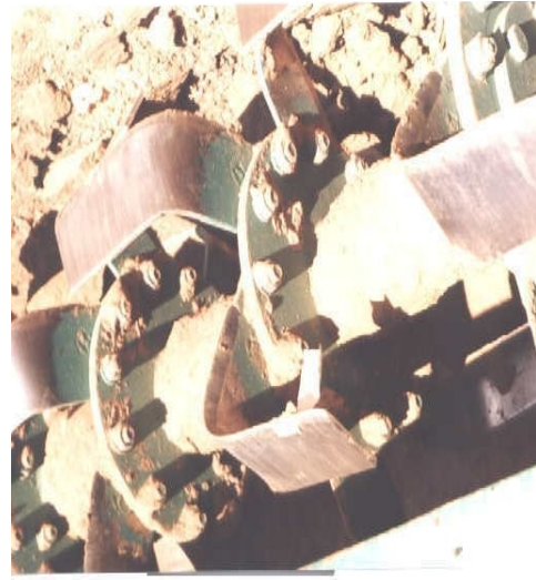
شکل ۱- تعویض تیغه های L شکل با تیغه های عمودی سه شاخه ای الف - تیغه های L شکل رایج ب - تیغه های جایگزین شده
