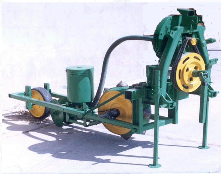
شکل (۳). تصویری از کارنده سمبهای ساخته شده در حالت توقف.
