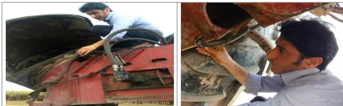
شکل ۳- نصب ۱ عدد دوربین زیر دروگر جهت تلفات کف بر و ۲ عدد دوربین بالای بالابر جهت تلفات عدم هماهنگی با سبد
