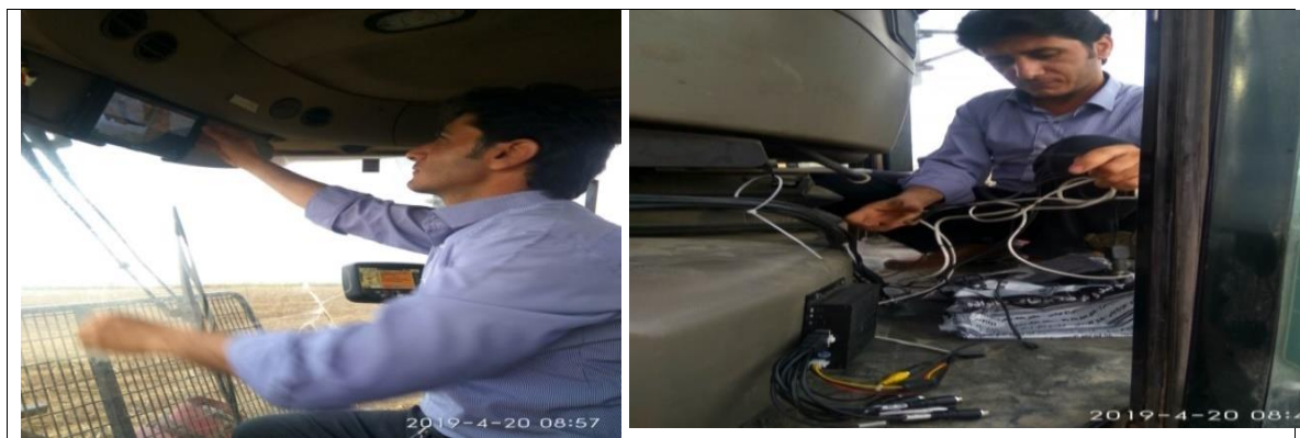
شکل (۲) نصب دی وی آر و نمایشگر برداشت در کابین دروگر
