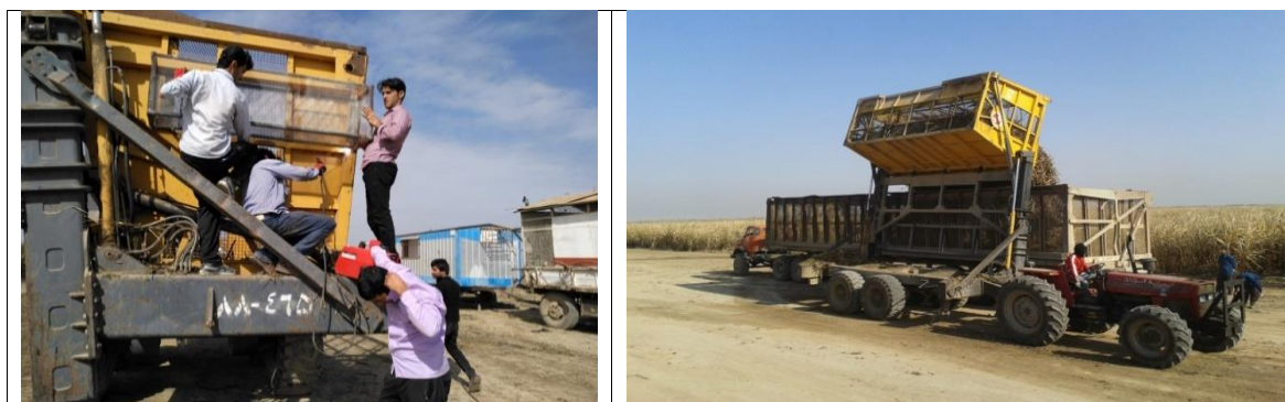
شکل(۴) تراکتور و سبد حمل نی در حال بارگیری تریلرهای حمل نی به کارخانه- نصب سبد های کوچک به سبد حمل نی
